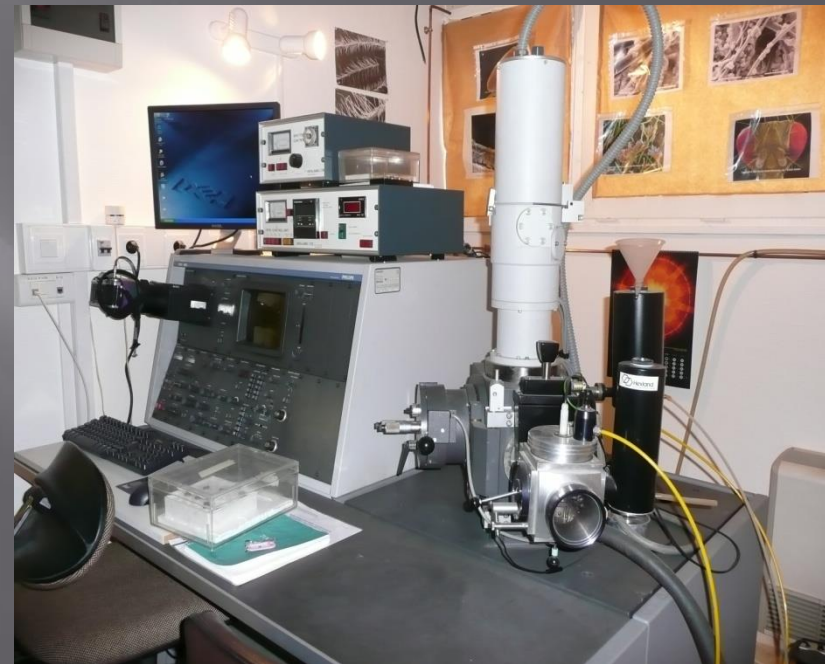
Dernier SEM 505 en état de marche et 1 er étage cryogénique Hexland installé en France (1983)
