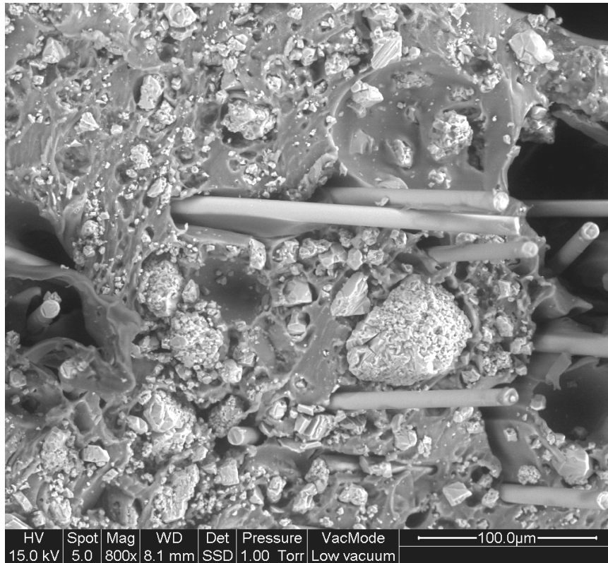
Composite : Matrice polymère/charges minérales renforcée par des fibres de verre
