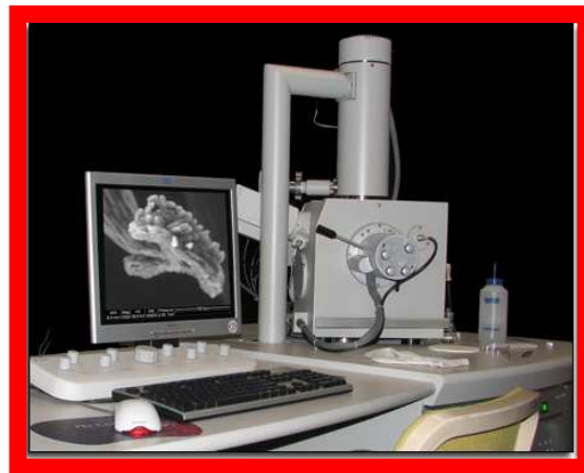
microscopie électronique à balayage (résolution 1nm pour les MEB FEG)
