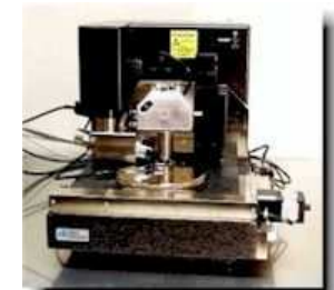
microscopies à champ proche (AFM, STM) (résolution subnanométrique)
