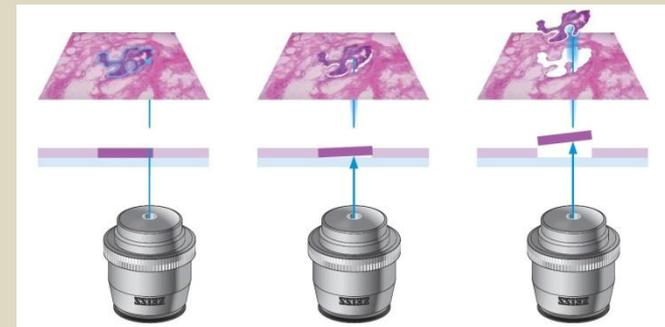
Déplacement de l'échantillon (platine motorisée) par rapport au laser focalisé fixe
